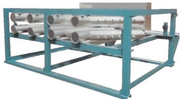
ストリップ乾燥システムには、化学薬品処理後用の間接型ガスヒーターが装備されています。このシステムは、72インチ(1830 mm)幅のストリップを最高600ft./min.(182 m/min.)の速度で乾燥するようにデザインされています。
