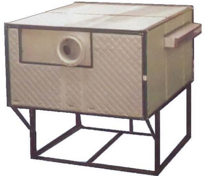
水平ヘダーのサポートテーブルには、4組の直径6インチ (152 mm)、30° “V” の、調整可能なスロットを備えたヘダー、出入り口のEDPMコーティングのヘダー保護ロール (表示されていません)、そして空気配布ボックスが装備されています。このユニットは、洗浄後の幅49インチ (1245mm) のスチール製のストリップを968 ft/min. (295 m/min.) の速度で乾燥させるために使用されます。
