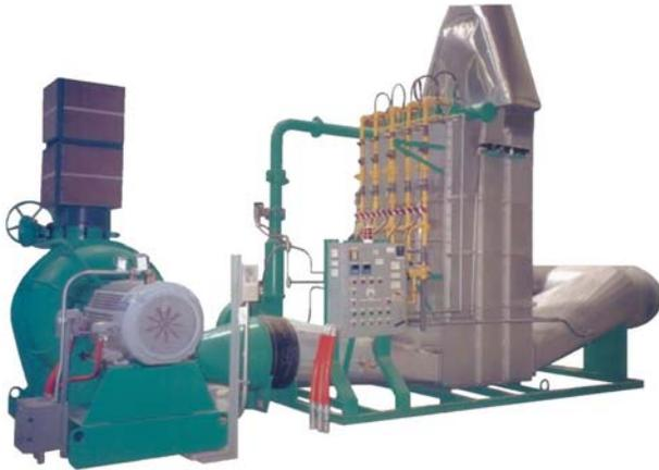
ストリップ乾燥システムには、スチーム・ヒーターがプッシュ・プル式酸洗浄部分に装備されています。このシステムは、72インチ (1830 mm) 幅のストリップを最高500 ft./min. (152 m/min.)の速度で乾燥するようにデザインされています。
