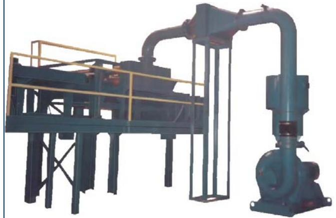
水平ヘダーのサポート構造には、3組の直径6インチ (152 mm)、15°“V”の調整可能なスロット付きのヘダー、出入り口のEPDMコーティングのヘダー保護ロール、および空気配布ボックスが装備されています。このユニットは、冷却後に49インチ (1245 mm)幅のストリップを最高600 ft./min. (182 m/min.)の速度で乾燥するようにデザインされています。
